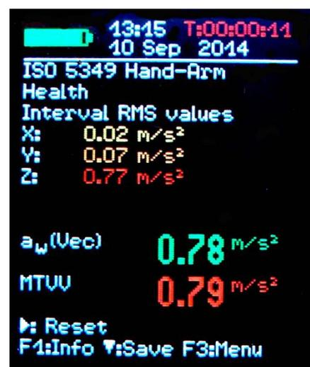
测量全程过载屏幕右上角日期后显示“OVL!”，可按 ▶ (Reset)键删除。
