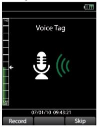
您可以在每次测量前,使用 VoiceTag 语音录音功能进行 30 秒钟的语音记录,直接对着传声器诉说即可,可记录测量时的相关信息,诸如日期时间测量地点人物等等。
