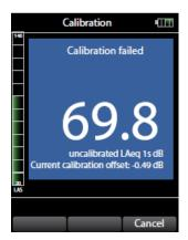
如果声级计测量的校准器声级不在测量范围内,校准失败。例如如果声校准器处于关闭状态或者处于错误声级状态,声级计将会识别并显示校准失败。按下 Cancel 取消键可随时中止校准。
