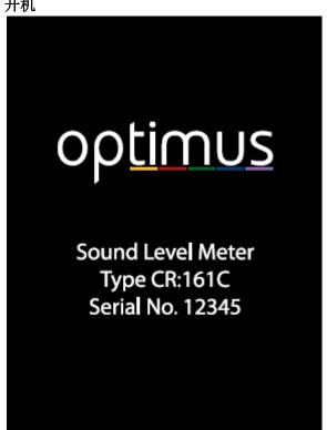
在开机前,请确保前置放大器和机体连接稳定。如果前置放大器没有连接好,屏幕会提示警 告信息,声级计无法使用。在安装前置放大器时,请确保声级计处于关机状态。
