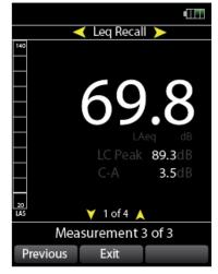
屏幕显示当前的测量编号,例如上图所示 Measurement 3 of 3。
