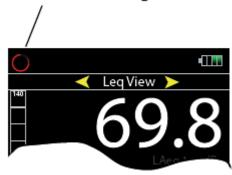
当测量开始时,屏幕左上方显示红色动态图标,无论屏幕显示何种测量结果,声级计测量和存储所有有效噪声参数。
